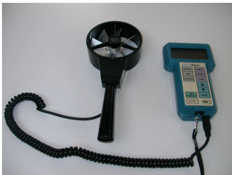
Figura 21 – Sensor de velocidade do ar tipo turbina.
