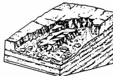
Figura 27: Esquema exemplificativo de um deslizamento translacional. (Amanti *et al.*, 1996). Fonte: Zêzere,2000
