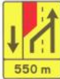
TD 18 — Painel de estrangulamento à esquerda (1x2+VL) — Desvio da via adjacente à via de lentos para a via de lentos Dim = 1,30 x 1,735 m
