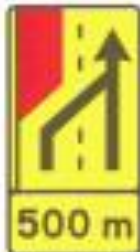
TD 20 — Painel de estrangulamento à esquerda (1x4) — Desvio da via esquerda para a via direita Dim = 0,925 x 1,735 m
