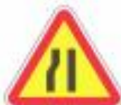
AT 6 — Passagem estreita
