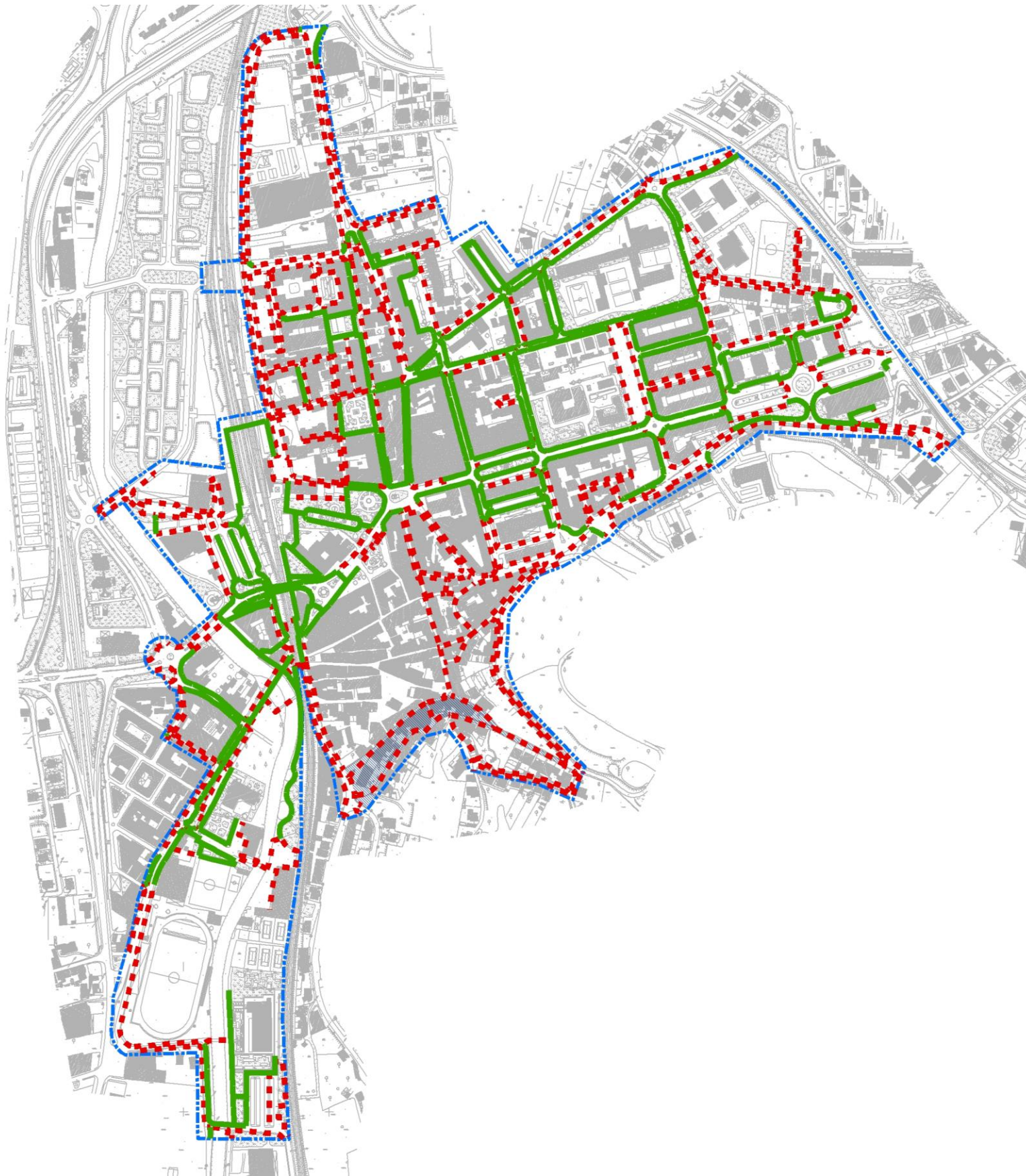
Figura 3.13. Rede de Percursos Acessíveis/Inacessíveis nas áreas de intervenção do Plano Local de Promoção da Acessibilidade – Programa RAMPA, município de Pombal
