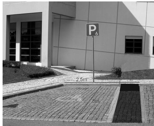
Figura 80: Estacionamento regulamentar.
