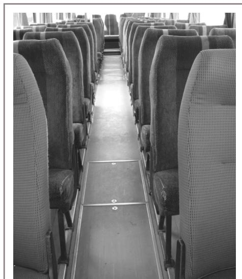
Figura 137: Exemplos de Corredores com dimensões reduzidas.
